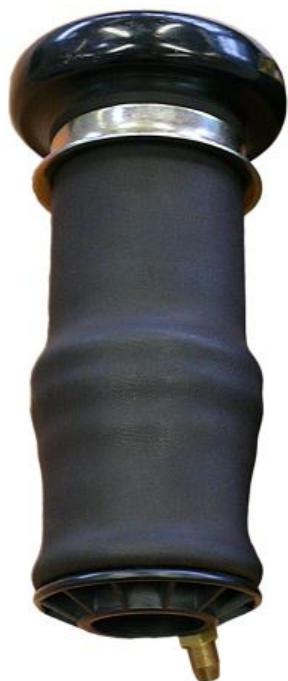
Рис. 1: Предыдущая конструкция модуля пневматической системы 557 001
