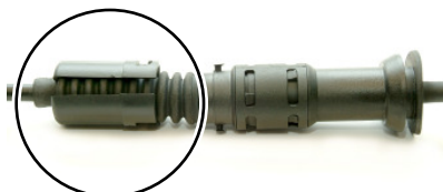
Рис. 3: Фиксатор ослаблен (байонетного патрона)
