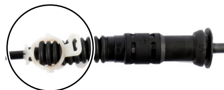
Рис. 4: Фиксатор ослаблен (белого пластикового хомута)
